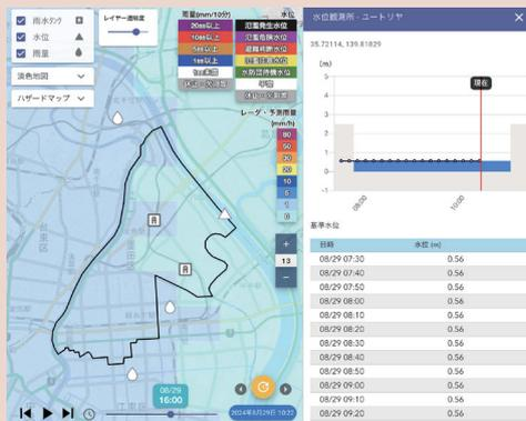
RisKmaを使って雨水タンクの水位を見える化し、パソコンやスマホでチェック。墨田区800か所の雨水タンク全体が空であれば、降雨量にして約2ミリ分の雨を貯められる
