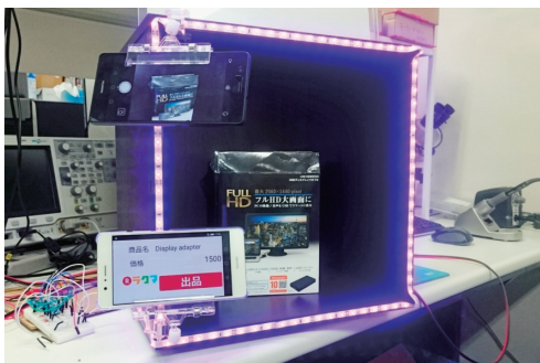
実装した販売ボックスのプロトタイプ。撮影用の画像認識用のカメラ(左上)、値札ディスプレイ(左下)を備える
